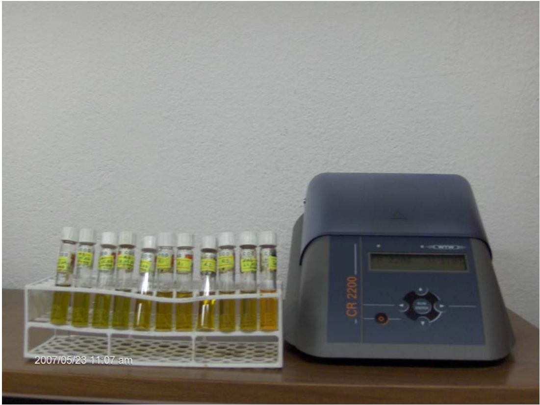
Resim 4.2. KOİ ölçümünde kullanılan reaktör ve deney tüpleri [50]
